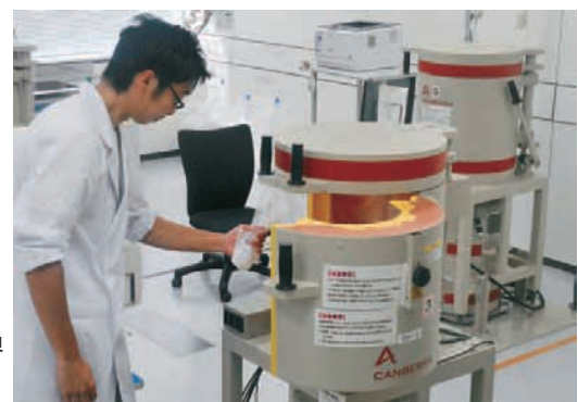
ゲルマニウム半導体検出器に福島県産米をかける職員 (平成23年9月15日 県農業総合センター) 平成23年9月16日 日本農業新聞掲載
