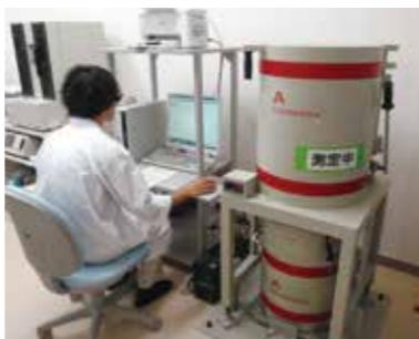
ゲルマニウム半導体検出器を用いて土壤の放射性物質濃度を測定
