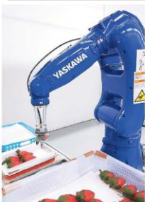
開発中のイチゴ選果ロボット（全農提供）
